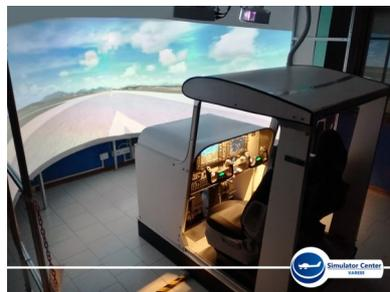
dell'Istituto Aeronautico di Varese "A. Ferrarin" è configurato in modo da simulare il Cessna 182T, permettendo di svolgere dal più semplice volo a vista, alla più impegnativa missione di volo strumentale. La conoscenza e l'impiego dell'avionica EFIS riduce il divario tra i classici velivoli impiegati in addestramento e i moderni liner permettendo una didattica innovativa e sempre aggiornata.
